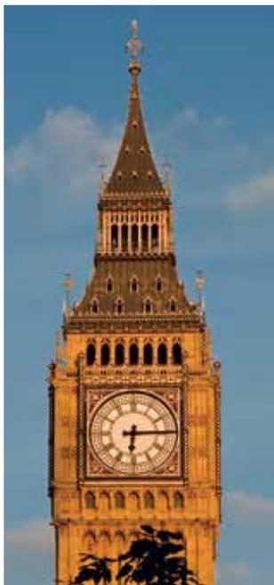
↑ Chacun des quatre cadrans de l'horloge a un diamètre de 7 m et se compose de 312 feuilles de verre.
